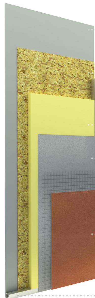
**Finition interne:** constituée de plaques de plâtre, plâtre de carrière renfermé entre deux feuilles de carton avec la fonction d'armature, d'épaisseur variable.
