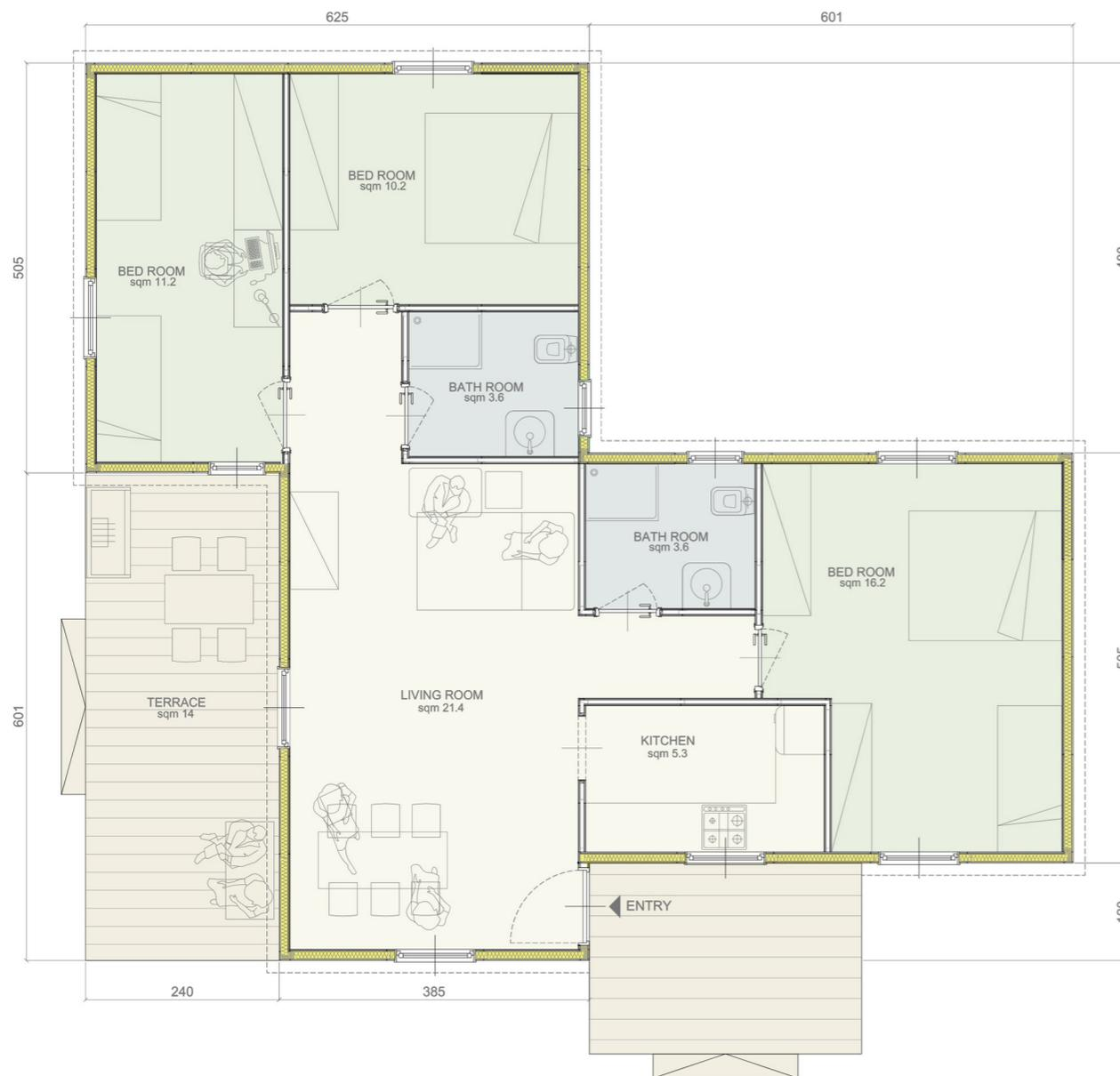
Concevoir un bâtiment de plan simple (d'où le nom du prototype), avec un plan rectangulaire qui comprend un Living Room avec cuisine locale distincte, une salle de bains et deux chambres. Cette distribution compacte est capable de limiter les coûts de la construction, ce qui le rend particulièrement compétitif.
